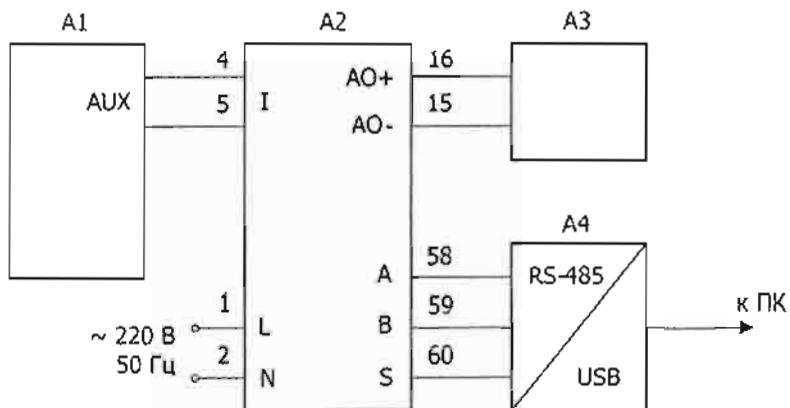
Рис А.1 – Схема подключения 1-канального амперметра постоянного или переменного тока, 1-канального вольтметра постоянного тока, предназначенного для работы с добавочным сопротивлением, с целью опробования интерфейса RS-485, определения погрешностей измерения силы тока, напряжения и частоты, проверки погрешности аналогового преобразования тока амперметром и напряжения вольтметром
