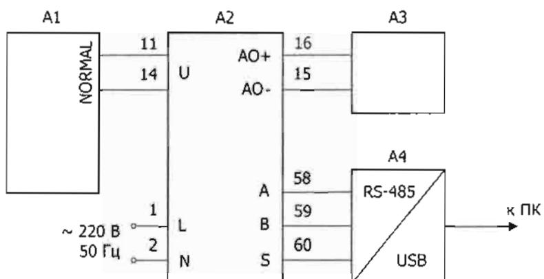
Рис А.2 – Схема подключения 1-канального вольтметра постоянного или переменного тока, 1-канального амперметра постоянного тока, предназначенного для работы с шунтом, с целью опробования интерфейса RS-485, определения погрешностей измерения напряжения, силы тока и частоты, проверки погрешности аналогового преобразования напряжения вольтметром и тока амперметром
